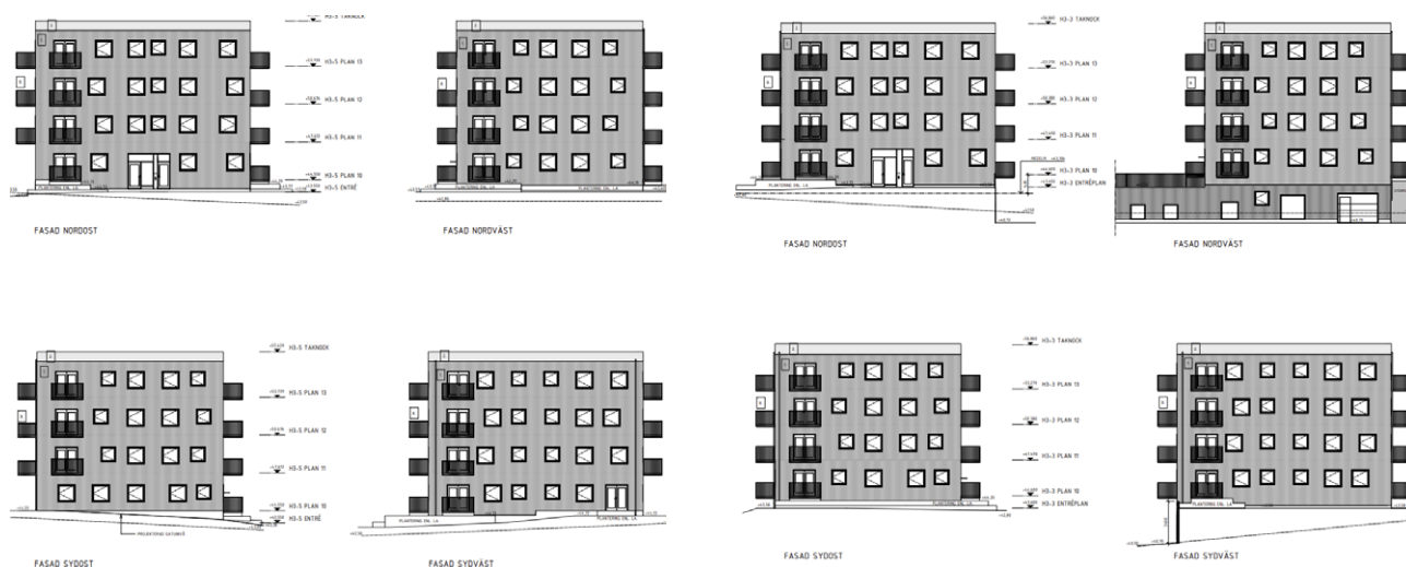
FIGUR 2: Översiktsbild av de studerade byggnaderna. Trähuset till vänster och betonghuset till höger.
